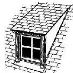
lucarne rampante ou en chien couché
