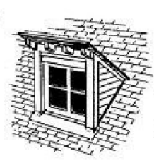
lucarne retroussée, ou demoiselle ; c'est aussi le vrai chien-assis
