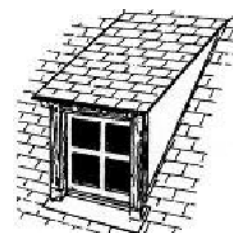
lucarne rampante ou en chien couché
