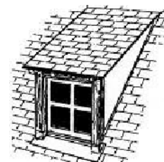
lucarne rampante ou en chien couché
